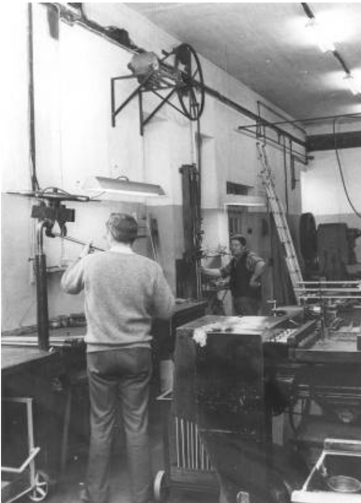
Inden piberne var klar til montering, blev løbene slebet og pudset adskillige gange. Her er Egon Jensen (bagest) i færd med at smergle, dvs. polere, løbene, som han netop har spændt op. Under loftet ses det excentriske hjul, der trækker smerglen gennem piberne. Efter den indvendige smergling blev piberne poleret udvendig med flere hold smergellærred med stadig finere kornstørrelse. Når piberne var spejlblanke, var næste trin i processen bruneringsbadet. Forrest med ryggen til står Uffe Schultz Larsen ved piberetteren. Foto Carsten Larsen ca. 1983.
