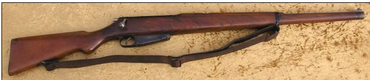
RPLT 42 blev kamret til den daværende danske standardmilitærkaliber, 8x58 RD. Foto Margit Egdal.
