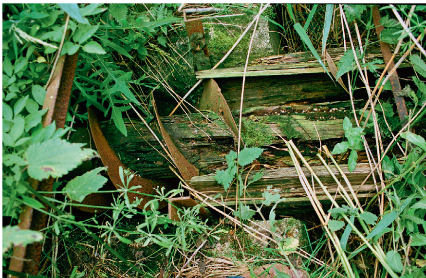
I græsset for foden af møllen ses stadig de frønnede rester af den oprindelige Archimedes-skrue med træcylinder, træaksel og jernblade, der »skruede« vandet ud i fjorden, når vinden drev motoren rundt. Foto: Morten Stenak, 2002.
